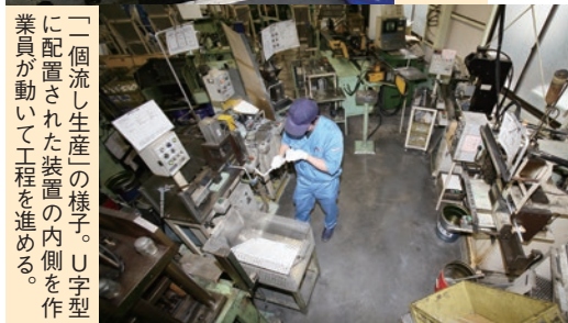
「一個流し生産」の様子。U字型に配置された装置の内側を作業員が動いて工程を進める。
