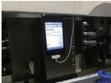
装置に取り付けられたiPod touch®。動作カウンターの表示画面にもなる。
