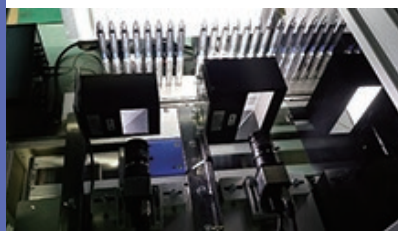
筆記用具外観検査工程 ロボットの心臓部。カメラで色や形状を判別して不良品をはじく。
