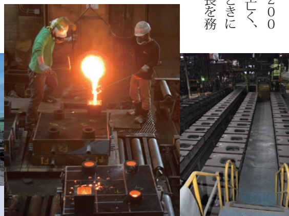
左: 溶かした金属を砂型に流し込む注湯作業。 右: 砂型の枠が並んだライン。
