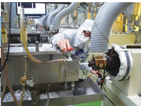
上：ストローの製造風景。空気の入量やけん引する力などを調節することで多様な製品が作れる。 右：工業用・医療用ストローのいろいろ。
